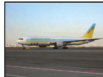
ボーイング767-300 座席数288席 全幅47.6m 全長54.9m 航続距離3,320km
