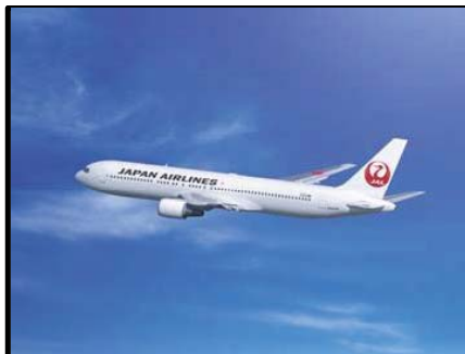
ボーイング767-300ER 座席数237席 全幅47.6m 全長54.9m 航続距離9,400km
