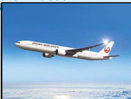
ボーイング777-300ER 座席数292席 全幅64.8m 全長73.9m 航続距離13,590km
