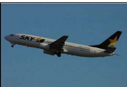
ボーイング737-800 座席数177席 全幅34.4m 全長39.5m 航続距離6,260km
